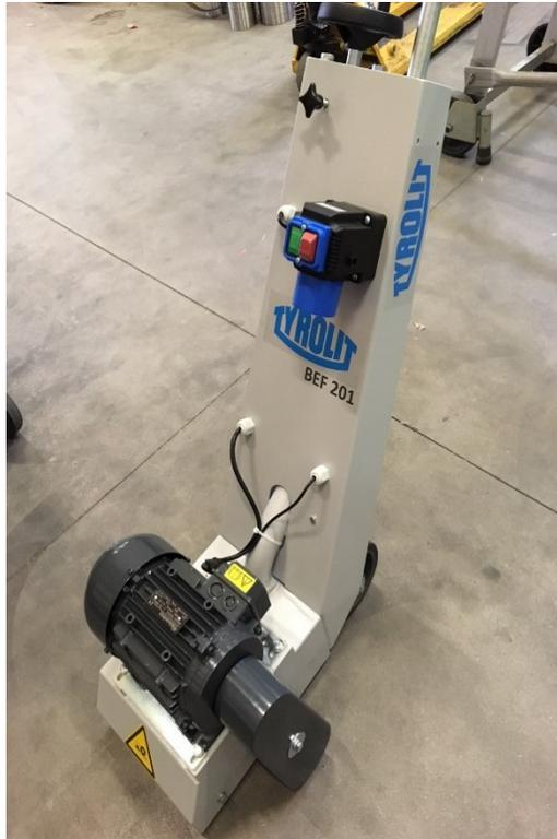
Macchina per scarificare pavimentazioni in cemento e asfalto, per superfici Medio - piccole;
